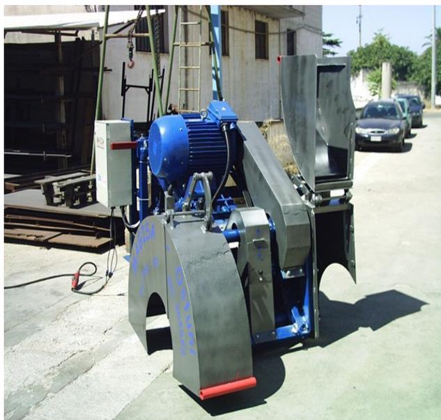
Adapto para cortar sulcos vertical com uma velocidade de corte de 0 ÷ 25 m/min.
